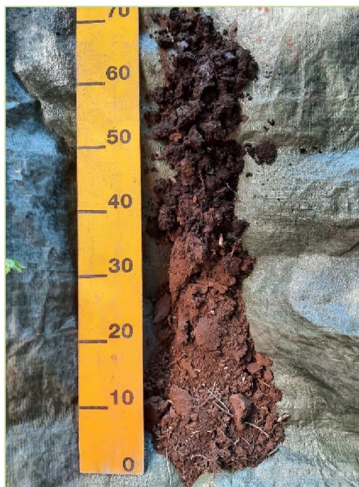
Detail profiel met duidelijke overgang naar veen op 40 cm (donkerdere kleur).
