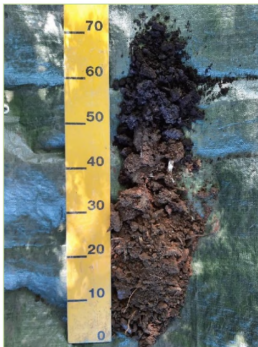
Detail profielboring. Duidelijke overgang op 50 cm van veraard veen naar veen (donkerder van kleur).
