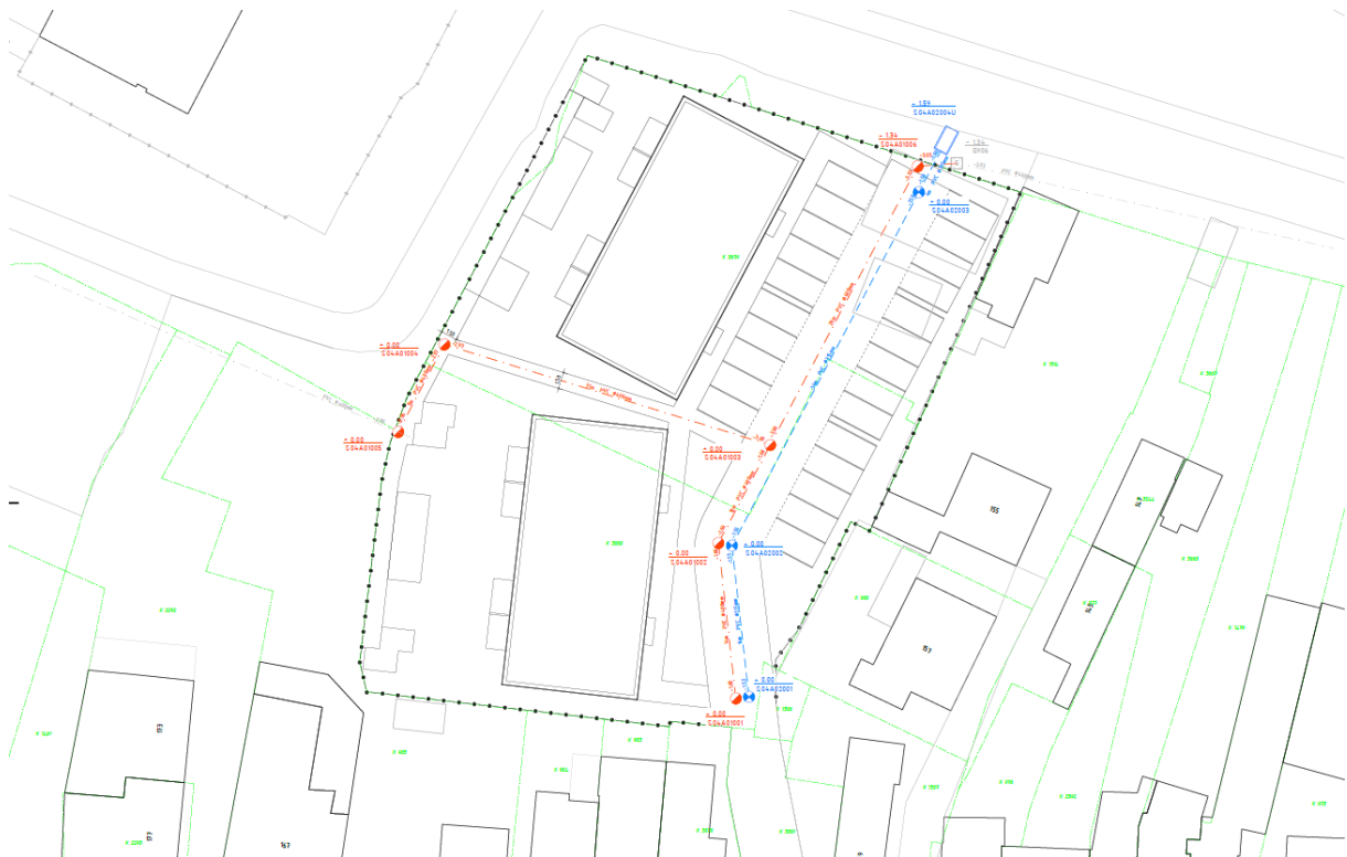
Afbeelding 20: Rioleringsstelsel nieuwe situatie
